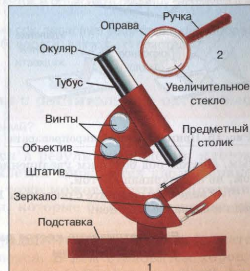
Рис. 14. Устройство микроскопа (1) и ручной лупы (2)
