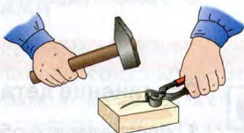
Рис. 53. Выпрямление согнутых гвоздей на бруске
