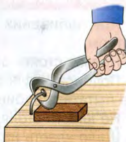
Рис. 51. Приёмы вытаскивания гвоздей: a — молотком; б — клещами
