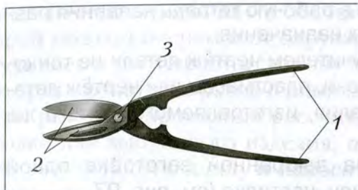
Рис. 112. Слесарные ножницы: 1 – ручки; 2 – лезвия; 3 – винт
