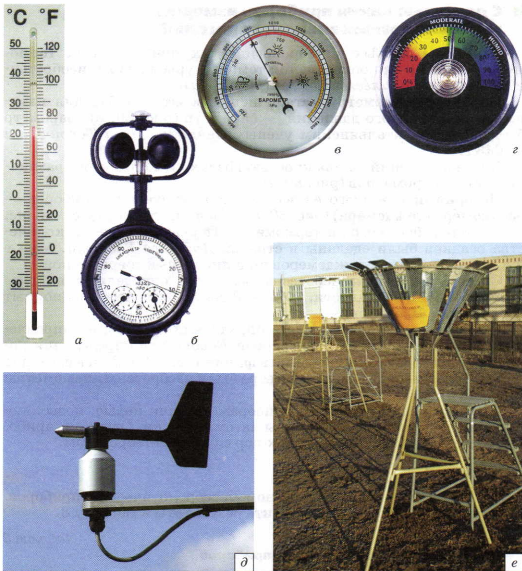
Рис. 80. Метеорологические приборы: а — термометр; б — анемометр; в — барометр-анероид; г — гигрометр; д — флюгер; е — осадкомер
